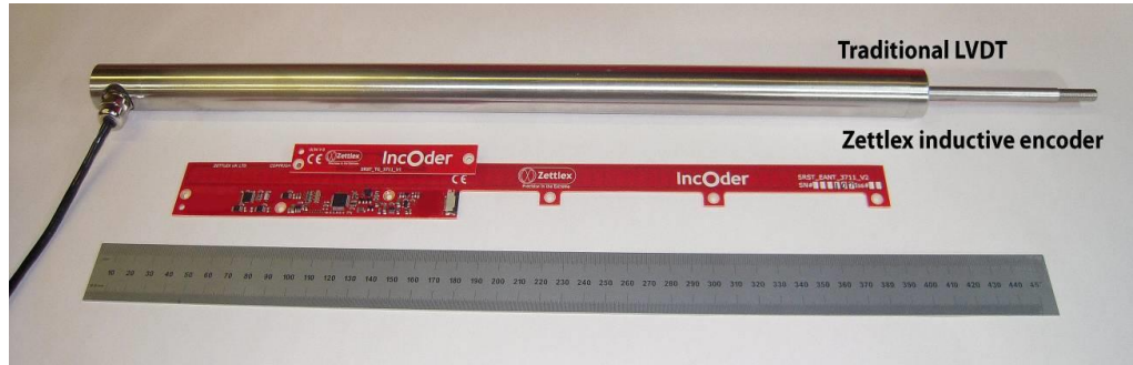
Geleneksel LVDT (üst) ve Zettlex lineer sensörün (orta) resmi. Ölçek için cetvel aşağıdadır.
