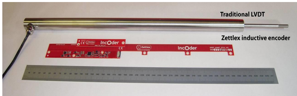
기존 LVDT(상)과 Zettlex 선형센서(중) 위치 비교(위쪽)
